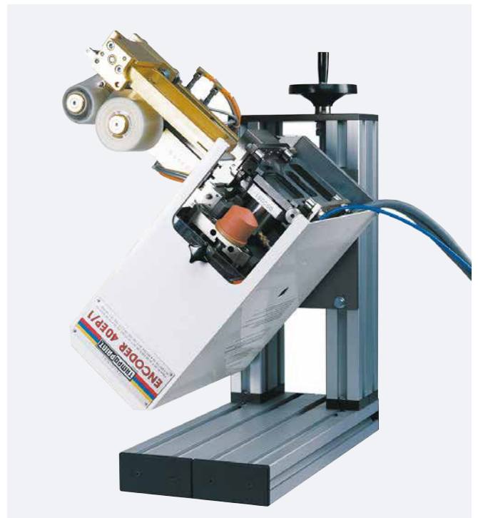
ENCODER 40 EP/1 Einbaulage zwischen 90–180° mit Option Restfarbenabholung
