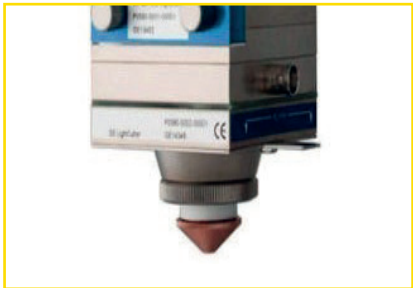
Testa capacitiva con sensore anticollisione
